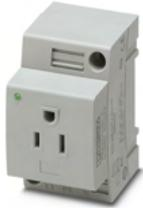
Toma de corriente, Cara enchufable tipo AB 15A, Conexión por tornillo, para EE.UU. y otros países, con indicador luminoso, gris, para el montaje sobre carril en la interfaz de servicio o montaje directo, 125 V AC, 15 A, -20 °C, 60 °C, UL 508
