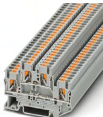
Borne de doble piso, tensión nominal: 500 V, corriente nominal: 22 A, tipo de conexión: Conexión push-in, 1er y 2º piso, Sección de dimensionamiento: 2,5 mm<sup>2</sup>, sección: 0,14 mm<sup>2</sup> - 4 mm<sup>2</sup>, clase de montaje: NS 35/7,5, NS 35/15, color: gris
