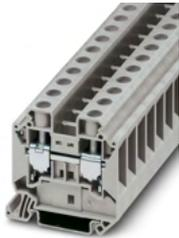
Borne de paso, tensión nominal: 1000 V, corriente nominal: 76 A, tipo de conexión: Conexión por tornillo, Sección de dimensionamiento: 16 mm<sup>2</sup>, sección: 1,5 mm<sup>2</sup> - 25 mm<sup>2</sup>, clase de montaje: NS 35/7,5, NS 35/15, color: gris
