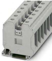
Borne de paso, tensión nominal: 1000 V, corriente nominal: 125 A, tipo de conexión: Conexión por tornillo, Sección de dimensionamiento: 35 mm<sup>2</sup>, sección: 1,5 mm<sup>2</sup> - 50 mm<sup>2</sup>, clase de montaje: NS 35/7,5, NS 35/15, color: gris
