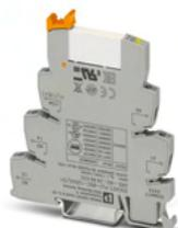
Interfaz PLC, compuesta por borne de base PLC-BSC.../21 con conexión por tornillo y relé miniatura enchufable con contacto de potencia, para el montaje sobre carril NS 35/7,5, 1 contacto conmutado, tensión de entrada 120 V AC/110 V DC
