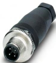
Conector, Universal, 4-polos, Conector macho recta M12, Codificación: A, Conexión por tornillo, material de moleteado: Fundición inyectada de cinc, niquelada, prensaestopas Pg7, diámetro exterior del cable 4 mm ... 6 mm
