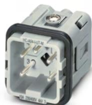
Inserto de contactos, número de polos: 4+PE, tamaño: D7, número de conexiones por polo: 1, Pin, Conexión por tornillo, 230 V/400 V, 10 A, 0,5 mm<sup>2</sup> ... 2,5 mm<sup>2</sup>
