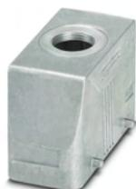
Carcasa aérea B16, para brida transversal, material: Fundición inyectada de aluminio, resistente al agua de mar, salidas de cable: 1, recta, 1x M32, altura: 60 mm, prensaestopas: sin, Estándar
